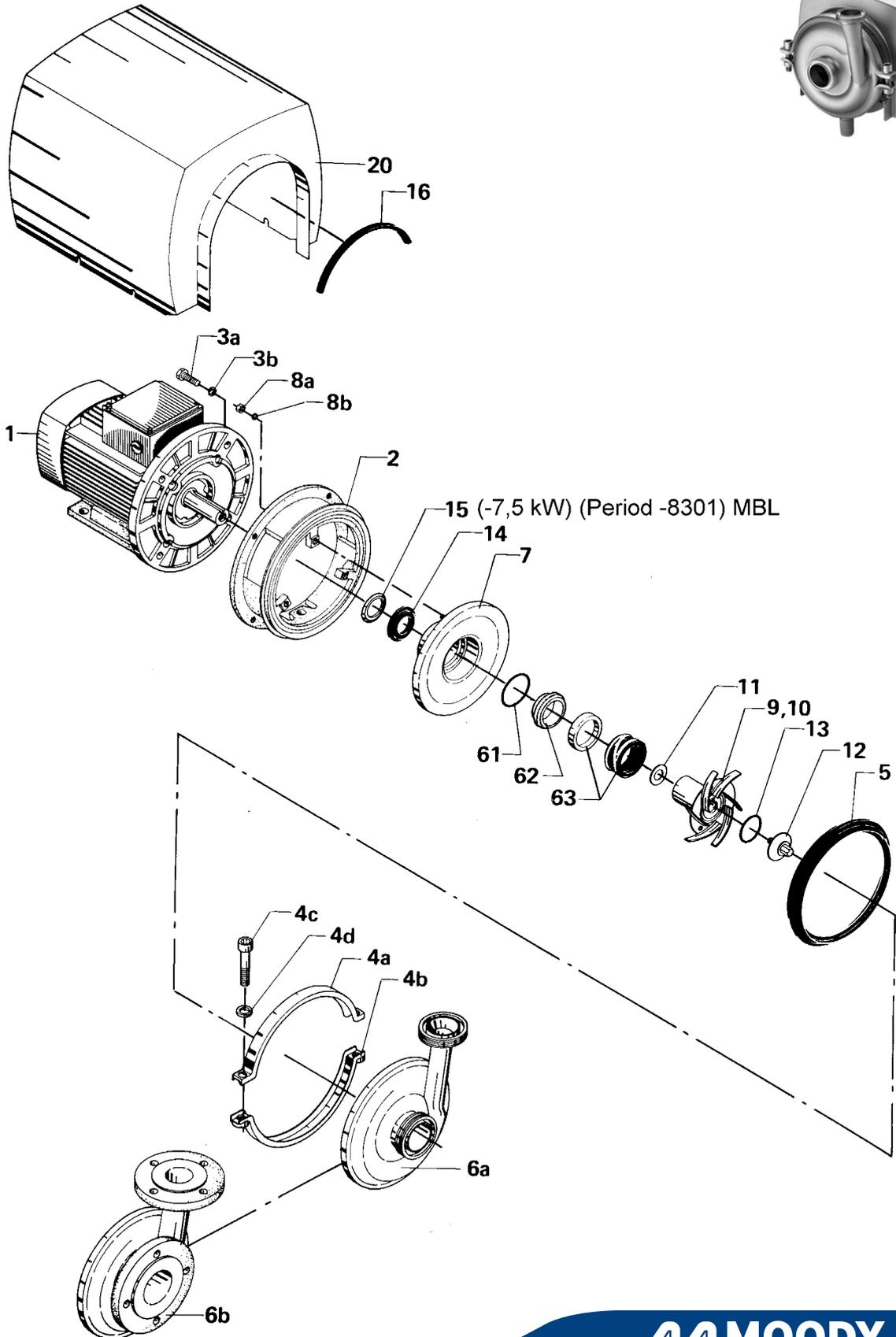
**Centrifugal Pump – Single Shaft Seal
